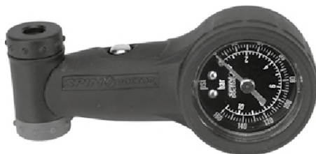
Рисунок 9. Портативный манометр для контроля давления в шинах (слева) и стационарный насос с манометром (справа)
