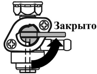
Рис. 12 Топливный кран закрыт
