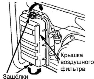
Рис. 21 Снятие крышки воздушного фильтра
