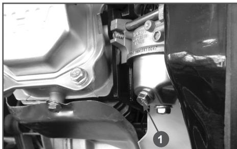
Рис. 26 Слив топлива из карбюратора
