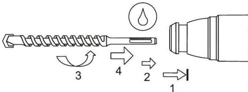
После закрепления бура наблюдается небольшое осевое биение, благодаря самой механике крепления. Чтобы снять бур, сначала ослабьте муфту, а затем удалите бур.
