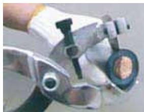
продольная резка изоляции
