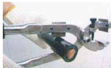
поперечная резка изоляции
