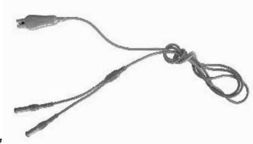
Normale rote Messleitung (Ein Stück. Sie dient zur einfachen Erdwiderstandsmessung)
