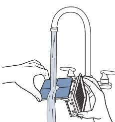
Вымойте фильтр и сетку вручную теплой водой с мягким моющим средством.
