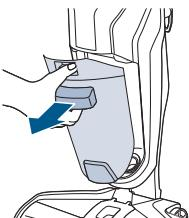
Нажав эту кнопку, потяните емкость для грязной воды на себя за имеющуюся на ней ручку и снимите ее с пылесоса.
