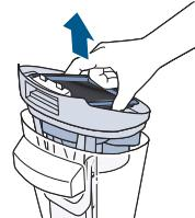
Возмите крышку емкости за углубления, имеющиеся на обеих сторонах фильтра, и извлеките ее из емкости движением «вверх».
