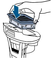
Вставьте фильтр обратно в крышку емкости для грязной воды.
