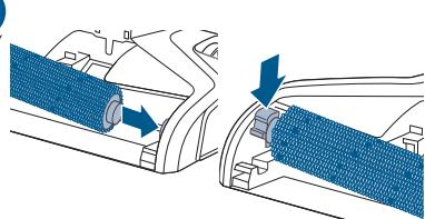
Установите щеточный валик на место, вставив его сначала в правую часть основной насадки, а затем слегка нажав на выступ так, чтобы зафиксировать валик.
