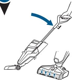
Наклоните корпус пылесоса назад; при этом начнет вращаться щеточный валик. Чтобы остановить его вращение, потребуется перевести корпус пылесоса в вертикальное положение.
