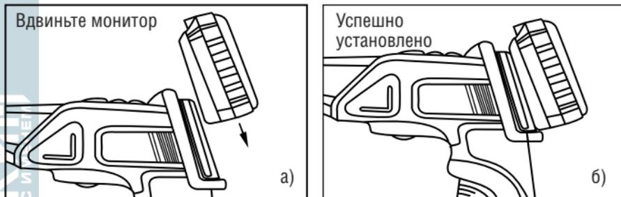
Рисунок 6 - Установка монитора на блок управления
