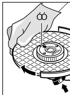
Для фиксирования шлифовального шпинделя нажмите кнопку блокировки
