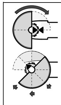
Насадите защитный кожух
