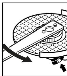
Правильно закрепленную, не имеющую повреждений быстрозажимную гайку Вы можете отвернуть, вращая рукой кольцо с накаткой против часовой стрелки.
