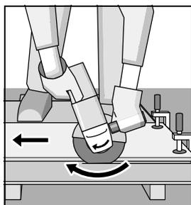
Всегда ведите электроинструмент против направления вращения. В противном случае возникает опасность неконтролируемого выхода из прорези.
