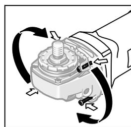
Редукторная головка может быть повернута ступенями по 90° Таким образом выключатель может быть установлен в удобное для работы
