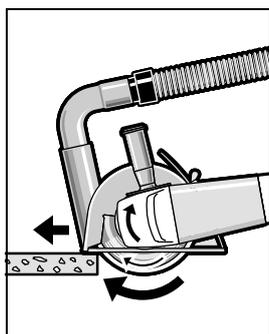
Включите электроинструмент и установите его передней частью направляющих салазок на деталь. Перемещайте электроинструмент с умеренной, соответствующей обрабатываемому материалу подачей.
