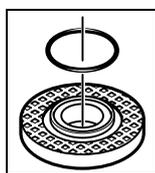
В посадочный фланец  $f_1$  вставлена вокруг буртика центрирования пластмассовая деталь (круглое кольцо). Если кольцо отсутствует или повреждено, то его следует обязательно установить или
