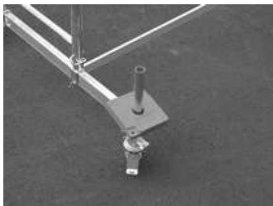
Оснащение траверс балластными грузиками
