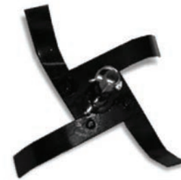
Дополнительная фреза необходима для увеличения ширины вспахивания
