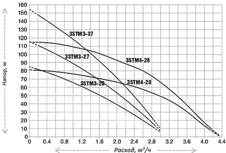
График расходно-напорных характеристик для насосов диаметром 4 дюйма:
