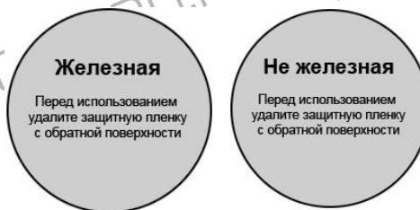
**※ При первом использовании снимите защитную белую матовую плёнку с эталонной шайбы (обратная сторона шайбы не используется)**
