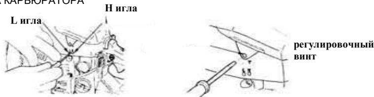
Карбюратор Вашей пилы был отрегулирован на заводе, возможно, потребует точная регулировка в связи с изменением рабочих условий.
