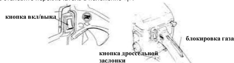
3. Вытащите головку рычага воздушной заслонки в положение закрытой заслонки. Воздушная заслонка закроется, и сектор газа тогда будет установлен в начальное положение.
