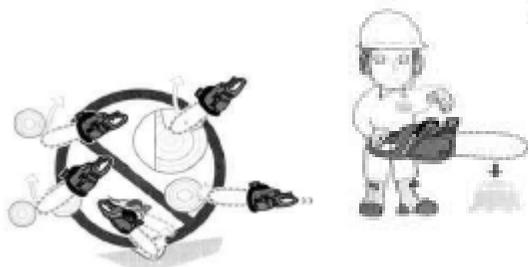
• Пила оснащена цепным тормозом, который при правильной работе останавливает цепь в случае отдачи. Проверяйте работу цепного тормоза перед каждым применением посредством пуска пилы на полном газе 1-2 сек и толканием переднего механизма защиты вперед. Цепь должна остановиться сразу, при работе двигателя с полной скоростью. Если цепь останавливается медленно или не останавливается, замените ленту тормоза и барабан сцепления перед применением.
