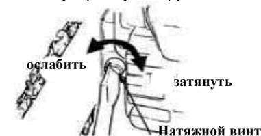
6. Удерживая конец пильной шины, отрегулируйте натяжение цепи поворотом винта до тех пор, пока скобы траверсы не соприкоснутся с нижней стороной направляющей шины.
