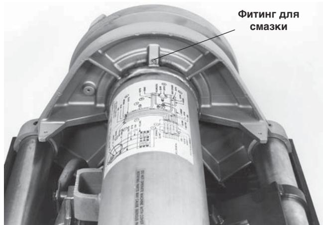
Рисунок 31 – Смазывание подшипников главного вала
