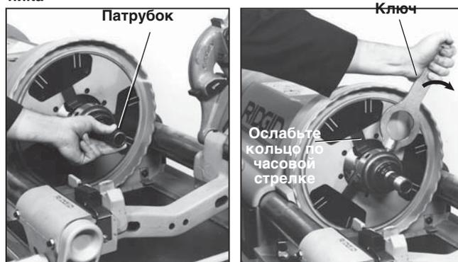
Рисунок 30 – Установка необработанного патрубка и освобождение готового патрубка с помощью ключа
