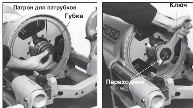
Рисунок 29 – Установка патрона для патрубков и переходника
