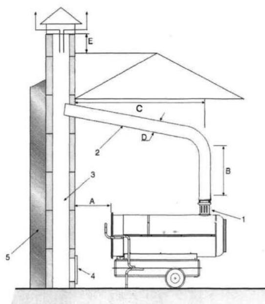
D Равно или больше диаметра трубы-переходника **теплогенератора**
