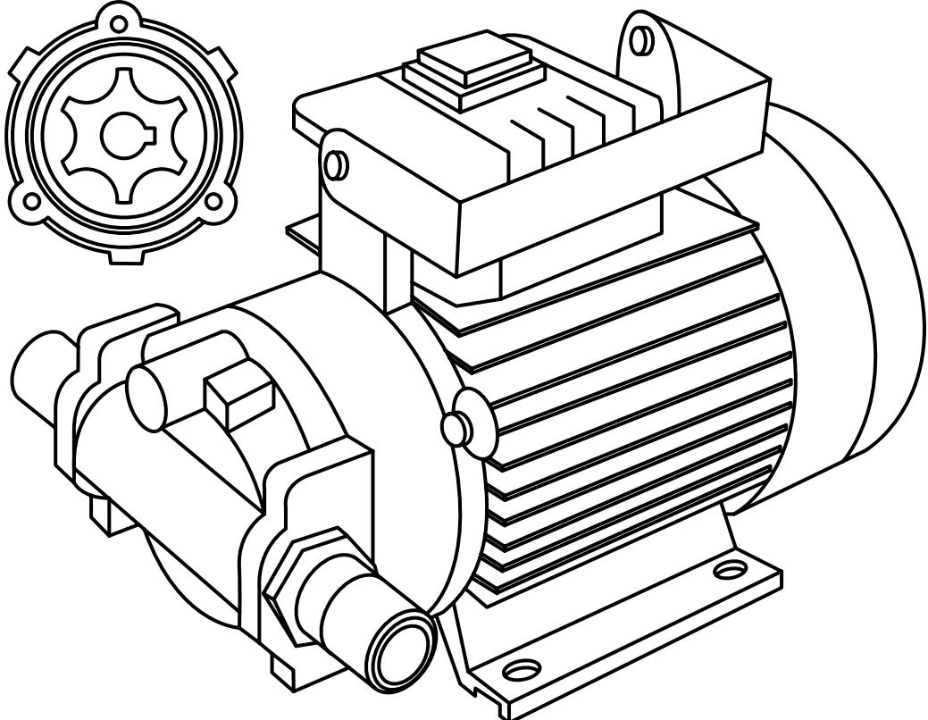
Насос для перекачки топлива и масел «БелАК» «Гермес» с напряжением питания 220 Вольт предназначен для перекачки дизельного топлива, керосина и моторных и трансмиссионных масел. Запрещено перекачивать данным насосом воду и жидкости на её основе, тяжелые нефтепродукты (мазут, отработанное масло), бензин, горючие спирты, растворители и другие легковоспламеняющиеся жидкости с высокой степенью летучести паров.
