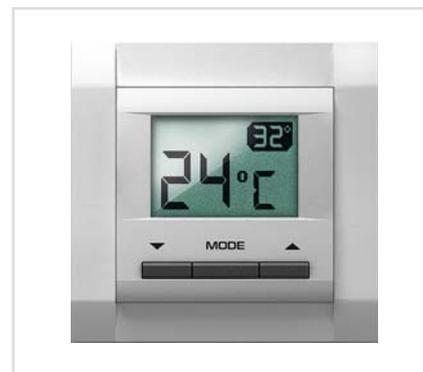
• **Индикация температуры пола и воздуха.** Два датчика температуры – выносной датчик температуры пола и встроенный датчик температуры воздуха – позволяют прибору работать в режимах индикации температуры окружающего воздуха (режим термометра) или индикации текущей температуры пола и температуры регулирования.
