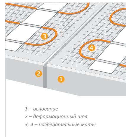
В случае, если здание имеет термокомпенсационные швы, нагревательные маты тонкого теплого пола ТЕПЛОЛЮКС должны быть расположены так, чтобы исключалась всякая возможность прохождения кабеля нагревательного мата через шов.
