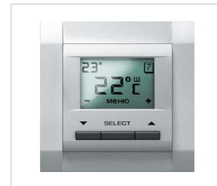
• **Адаптация к Вашему образу жизни.** Функция программирования позволяет выбрать часы, в которые пользователю необходима включенная система обогрева, а также задать время включения системы обогрева на всю неделю.
