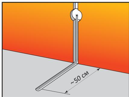
d. Закрепите трубку на полу небольшим количеством раствора для крепления плитки.
