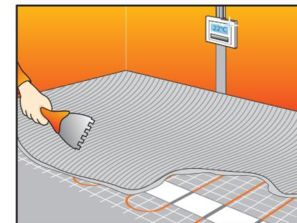
При нанесении и отверждении плиточного клея температура основания и окружающего воздуха должна быть от +5°C до +25°C. В помещении, где будет производиться работа, не должно быть сквозняков.
