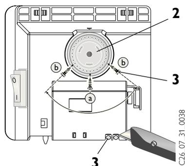
Для фиксации желаемой температуры штифт **a** следует вставить точно в напротив расположенное отверстие.
