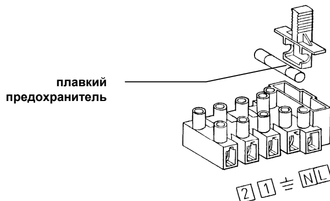
Рис. 7: Клеммная колодка электропитания
