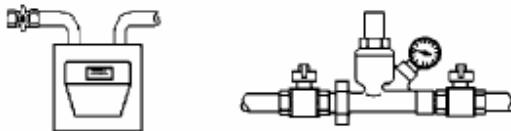
□ Проверить чтобы давление в системе отопления без нагрева было не ниже 1 бара но и не выше допустимой для данной модели нормы □ В противном случае необходимо связаться с сервисным центром □ □
