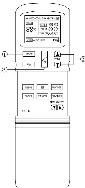
При отключении кондиционера текущие настройки сохраняются в памяти микропроцессора. При последующем включении нажатием кнопки I/O (ВКЛ/ОТКЛ) пульта дистанционного управления кондиционер начнет работать с ранее заданными настройками.
