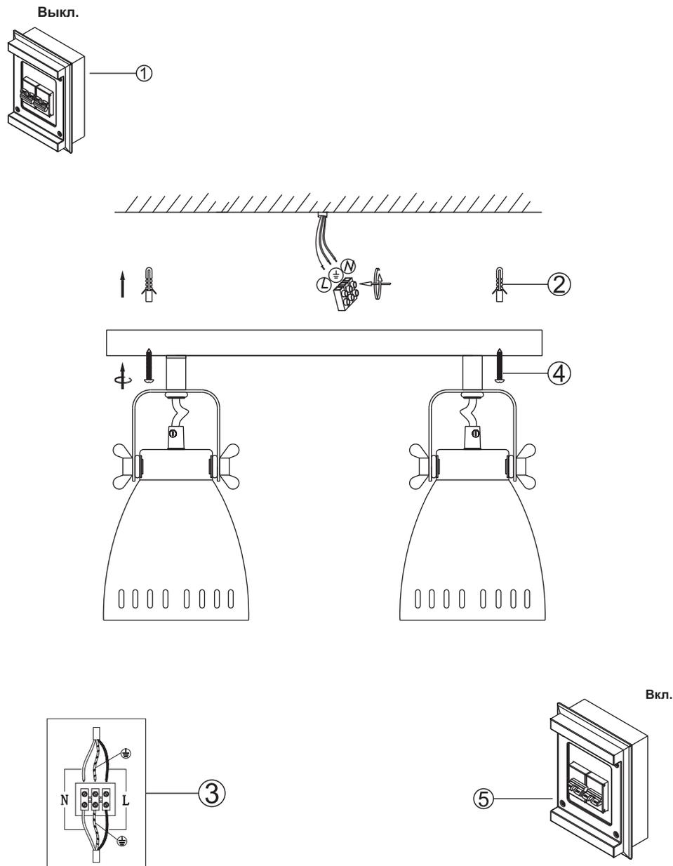
Рис.2 Установка светильника.
