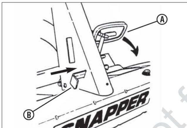
Рис. 16. Установка стояночного тормоза
