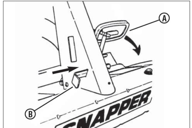
Рис. 8. Включение стояночного тормоза
