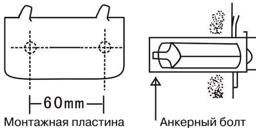
Установите водонагреватель на монтажную пластину. Нажмите на водонагреватель сверху вниз и убедитесь, что он надежно закреплен.
