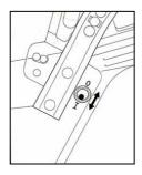
Включить электрический обогрев рукоятки \* (см. «К данному руководству по эксплуатации»)
