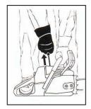
о Правой рукой вытянуть медленно до упора пусковую ручку и после этого протянуть быстро и сильно − тросик допускается вытягивать, однако, на длину не более 70 см − опасность разрыва!
