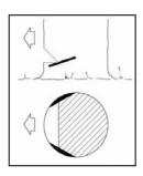
Заболонные пропилы предотвращают у длинноволокнистой древесины разрыв заболони при падении ствола. — Врезание производите с обеих сторон ствола на глубину приблизительно 1/10 диаметра ствола, - у толстых стволов максимально на ширину направляющей шины.
