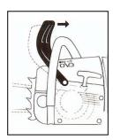
• Защитное устройство для рук оттяните к рубчатой рукоятке. Тормоз пильной цепи отпущен. – Мотопила готова к работе
