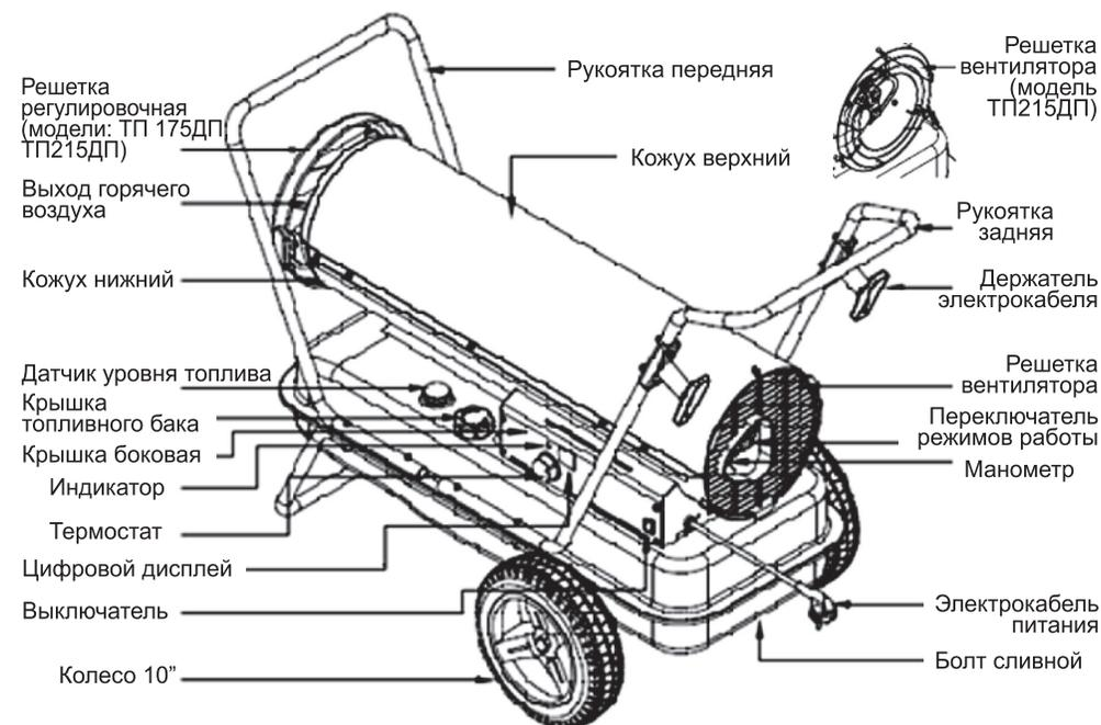
Рис 2. Модели: ТП 125ДП, ТП 175ДП, ТП215ДП
