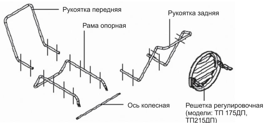
Рис 5. Рама опорная (модели ТП125ДП, ТП175ДП, ТП215ДП)
