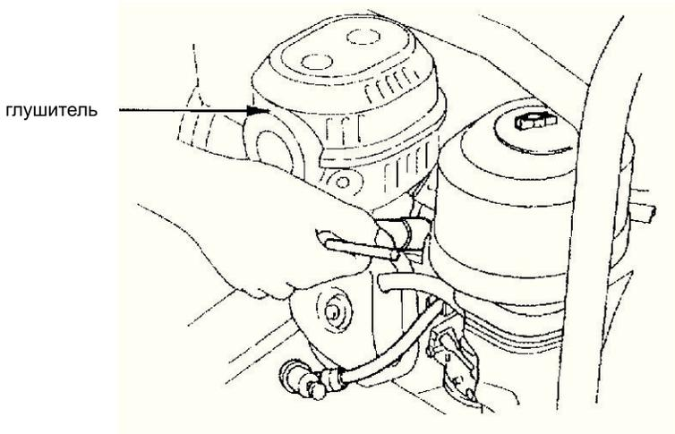
2. Осмотрите свечу. При явном износе, лопнувшем или выщербленном изоляторе свеча непригодна для работы. Если свеча может быть использована далее, почистите ее проволочной щеткой.
