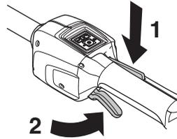
Проверьте, чтобы переключатель был зафиксирован, когда его стопор находится в исходном положении.
