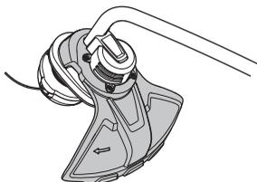
Проверьте, чтобы защита не была повреждена и чтобы на ней не было трещин. Замените защиту, если она была подвержена удару или если на ней есть трещины.
