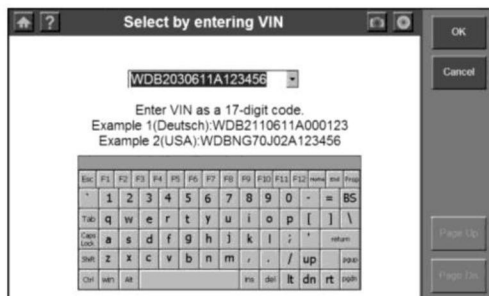
Рисунок 3-15. Окно для ручного ввода VIN-номера
