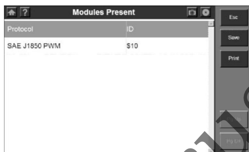
Рисунок 3-56. Окно Modules Present [Доступные модули] (OBD II)
