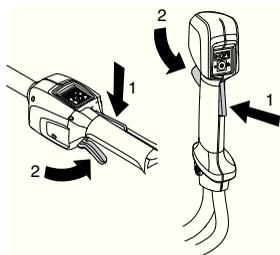
Проверьте, чтобы переключатель был зафиксирован, когда его стопор находится в исходном положении.
