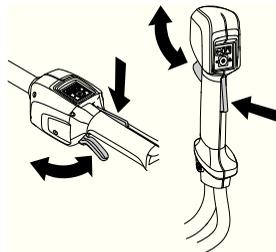
См. указания в разделе Запуск. Запустите машину на полную мощность. Отпустите переключатель и удостоверьтесь, что режущее оборудование останавливается и остается неподвижным.
