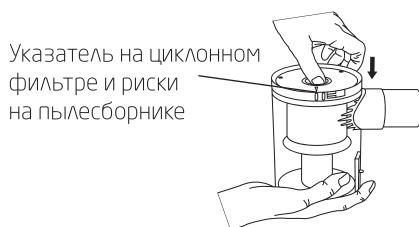
**Циклонный фильтр.** Периодически следует промывать циклонный фильтр и пылесборник. Снимите верхнюю крышку пылесборника и выньте фильтры. Откройте нижнюю крышку пылесборника и снизу вверх вытолкните циклонный фильтр. Промойте его, высушите и установите назад. При установке циклонного фильтра укажите
