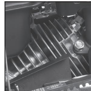
Двигатель, ребра цилиндра / Цилиндр
