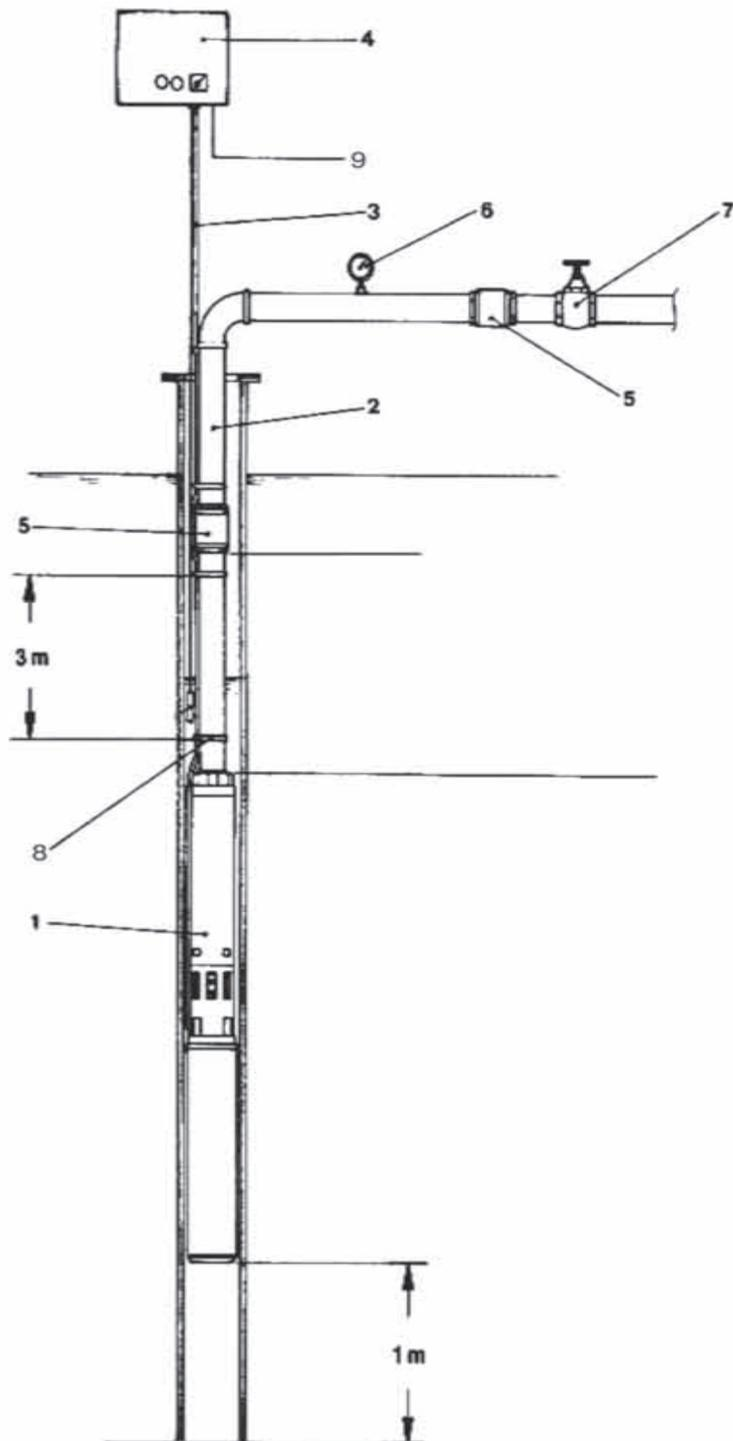
4.4 Шланг при эксплуатации укладывайте без скручивания и перегибов. Во избежание перегрева и порчи излишков питающего кабеля во время работы насосов с напором 40, 50, 63, 80, 100 м не оставляйте его в плотно смотанной бухте, затрудняющей доступ воздуха для охлаждения кабеля.
