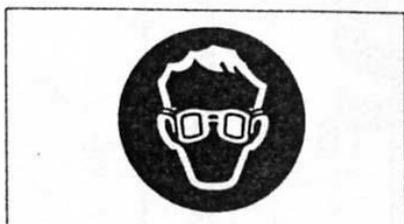
При работе используйте защитные приспособления для защиты органов слуха и глаз. Используйте очки с боковыми защитными пластинами. Надевайте наушники. Работодатель и рабочий несут ответственность перед третьими лицами, находящимися в зоне работы пистолета. Все люди, находящиеся рядом с эксплуатируемым пистолетом должны надевать наушники.
