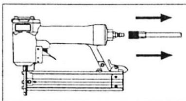
14. Обязательно отключите подачу воздуха перед техническим обслуживанием пистолета, регулировкой, или во время перерывов в работе.
