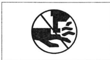
17. При отключении или подключении подачи воздуха будьте аккуратны, не подставляйте руки и другие части тела под выходное отверстие пистолета.
