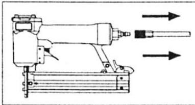
Обязательно отключите подачу воздуха перед техническим обслуживанием пистолета, регулировкой или во время перерывов в работе.
