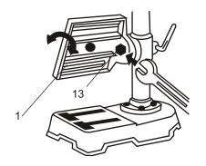
Для косого сверления или в случае обработки наклонной детали можно изменить угол наклона рабочего стола(1). Для этого ослабьте винт регулировки угла наклона (13), после чего установите рабочий стол в нужное положение, и зафиксируйте это положение винтом регулировки наклона поворотного стола (13) при помощи гаечного ключа.
