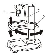
Рабочий стол (1) фиксируется на колоне(2). При необходимости передвинуть его вдоль по колоне, достаточно ослабить рычаг блокировки (6). Установите рабочий стол (1) на высоту, достаточную для сверления детали таким образом, чтобы оставалось место между верхней частью детали и концом сверла. Вы также можете повернуть рабочий стол, если необходимо сверлить слишком высокую деталь, которую можно поместить непосредственно на основание (3).
