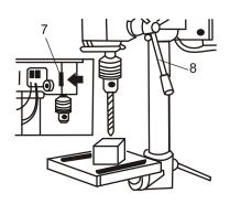
Ограничитель глубины сверления с шкалой, позволяет с точностью установить глубину сверления. Установка происходит следующим образом: с помощью ручки (8) слегка надавите концом сверла на верхнюю часть детали и отрегулируйте глубину сверления по шкале завернув до упора гайку (7).
