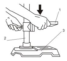
Ввинтить колону (2) в основание (3), надеть на колонку (2) рабочий стол (1) и установить на колону (2) привод со шпиндельной головкой. Установить три ручки управления (5) на привод пиноли и вставить патрон (4) в конус морзе шпинделя.
