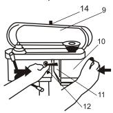
При замене ремня или при изменении скорости сверления откройте крышку защитного кожуха(9), ослабьте натяжение ремня ослабив винт (12) и переместив двигатель влево как показано на рисунке. После чего поменяйте положение ремня на ременных роликах. Выбрав необходимое положение, зафиксируйте его зажав натяжную пластину при помощи зажимного винта (12).
