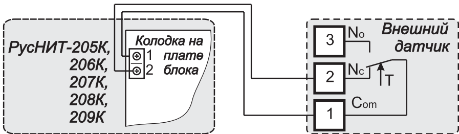
Рис. 9. Схема подключения выносного датчика температуры.
