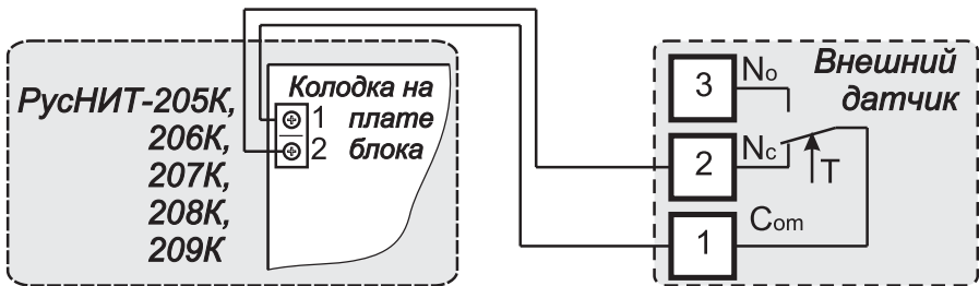
Рис. 9. Схема подключения выносного датчика температуры.
