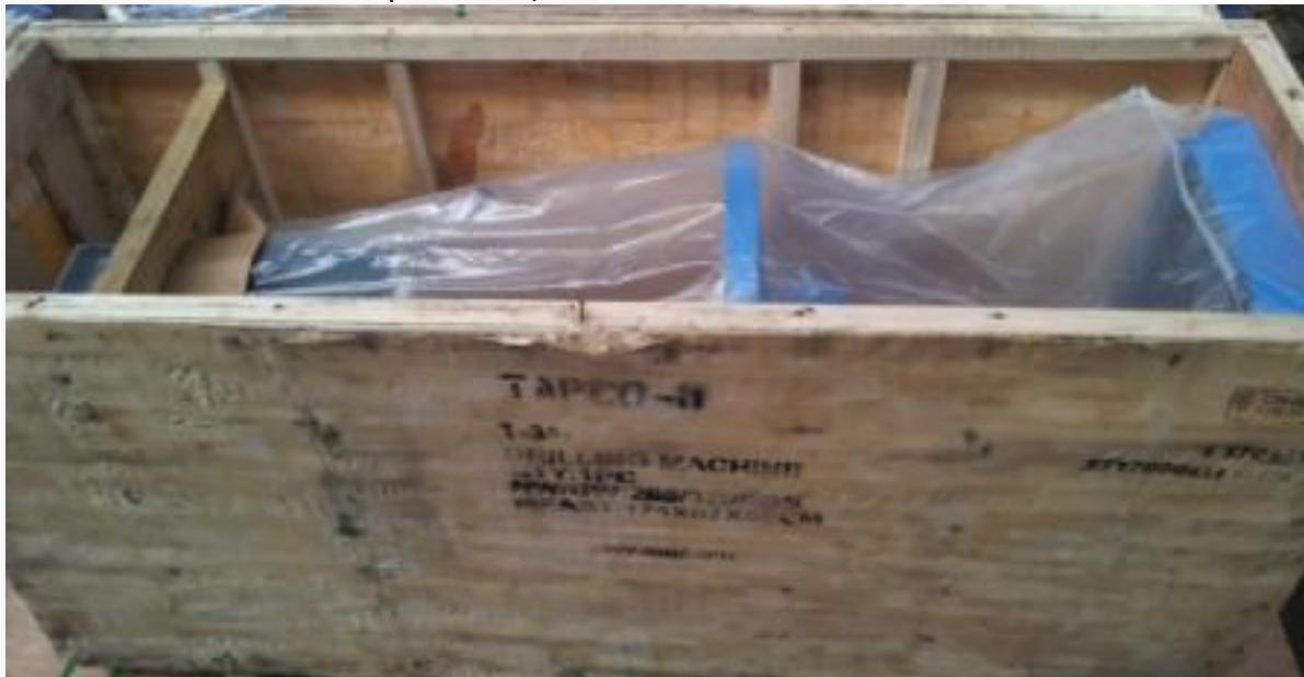
Для транспортировки используйте вилочный погрузчик или ручную тележку. Убедитесь, что станок не может опрокинуться или упасть во время транспортировки.
