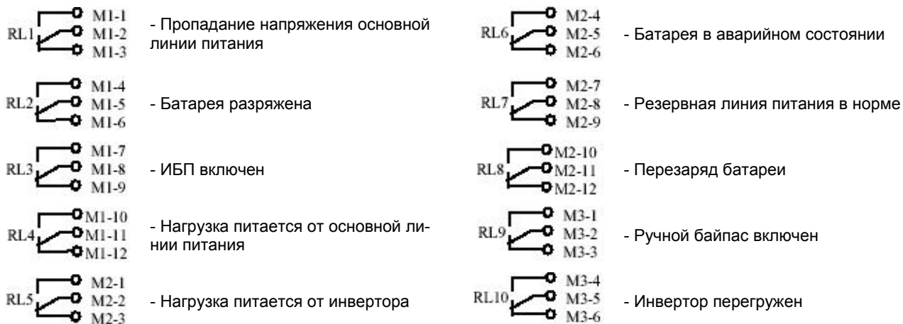
РИСУНОК 7: ОПИСАНИЕ ОТКРЫТЫХ КОНТАКТОВ РАЗЪЕМА DB9.
