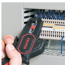
удаление изоляции в стесненных условиях
