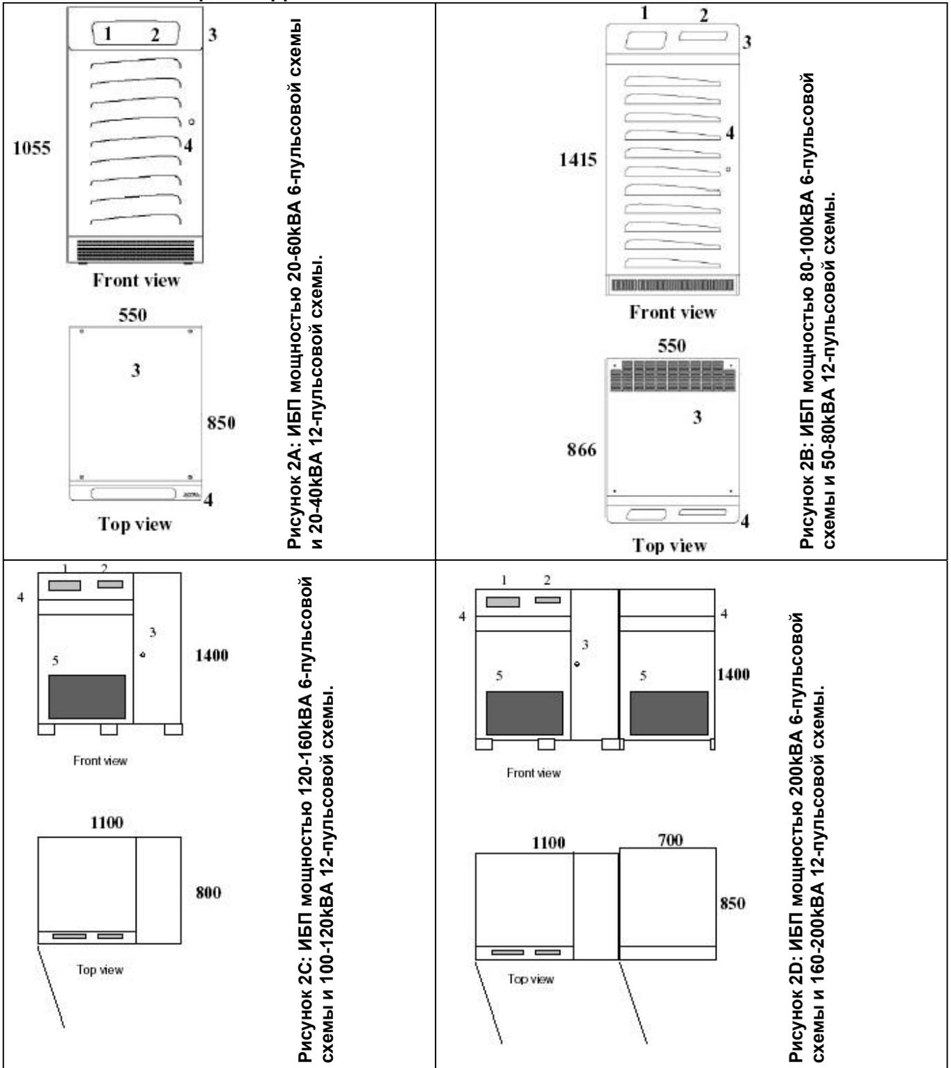
Рисунок 2А: ИБП мощностью 20-60кВА 6-пульсовой схемы и 20-40кВА 12-пульсовой схемы.
