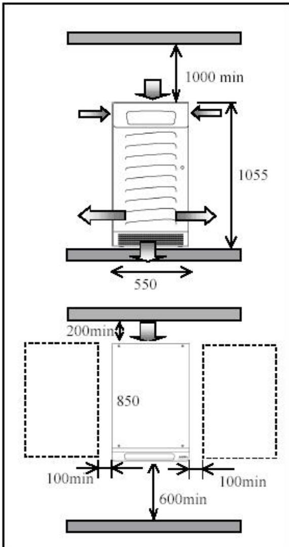
Если вокруг ИБП недостаточной свободное пространство, для производства неординарных работ по обслуживанию ИБП следует применять более длинные соединительные провода (Для удобства перемещения ИБП они снабжены колесиками с тормозами). Закрашенные стрелки указывают направление воздушного потока (забор холодного воздуха сверху – выход его снизу).
