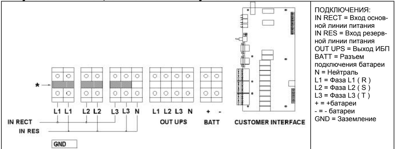
\* В стандартной конфигурации для одиночной линии питания мы поставляем перемычки между входом выпрямителя и входом резерва. В случае применения двух питающих линий эти перемычки должны быть убраны.
