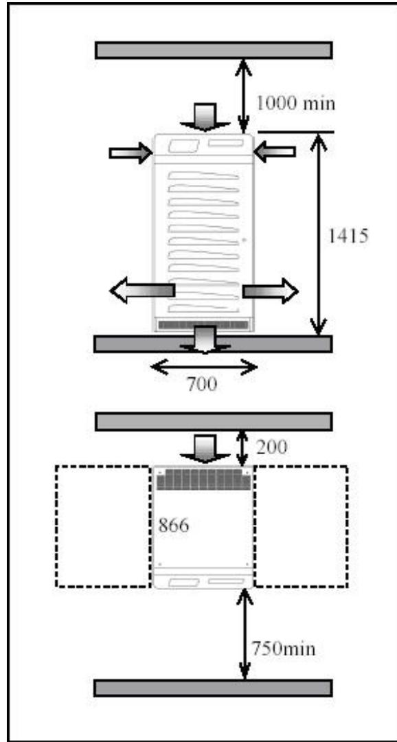
ИБП могут вплотную прислоняться к стене, размер 200 мм является всего лишь справочным. Если устроить достаточный зазор между стеной и ИБП невозможно, длина кабелей должна выбираться с запасом, для того, чтобы в случае неординарного ремонта откатить ИБП. Закрашенные стрелки показывают направление воздушного потока (С целью уменьшения забора пыли, охлаждающий воздух забирается сверху и выпускается
