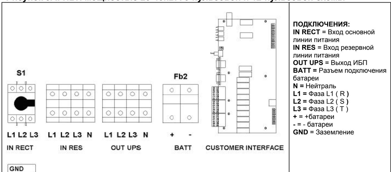
**Рисунок 9В: ИБП мощностью 50-60кВА 6-пульсовой схемы.**
