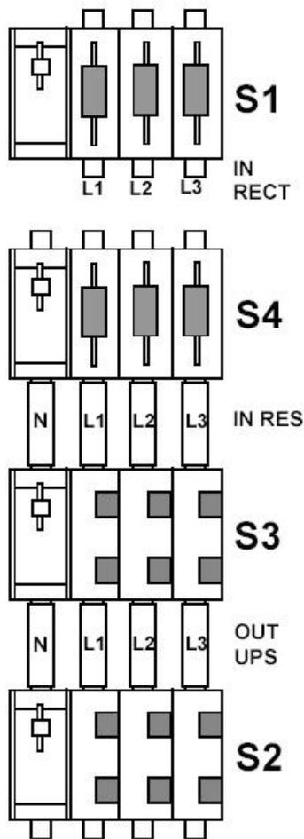
**ПОДКЛЮЧЕНИЯ РАЗЪЕДИНИТЕЛЕЙ В СИЛОВОМ ОТСЕКЕ**
