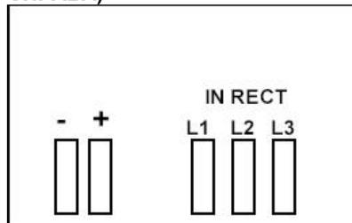
IN RECT= Подключение основной линии питания
