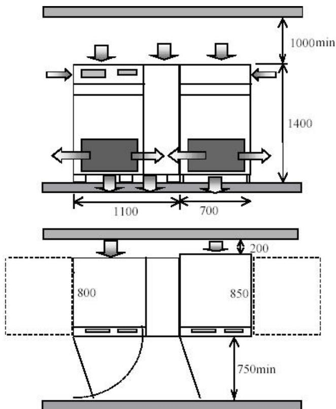
ИБП могут вплотную прислоняться к стене, но для забора охлаждающего воздуха необходим зазор 200 мм. Если устроить достаточный зазор между стеной и ИБП невозможно, длина кабелей должна выбираться с запасом, для того, чтобы в случае неординарного ремонта откатить ИБП. Закрашенные стрелки показывают направление воздушного потока (С целью уменьшения забора пыли, охлаждающий воздух забирается сверху и выпускается снизу ИБП).
