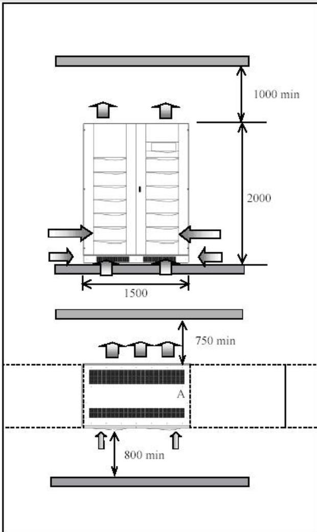
Для ИБП мощностью 200, 250 – 300 кВА размер А=930 мм.
