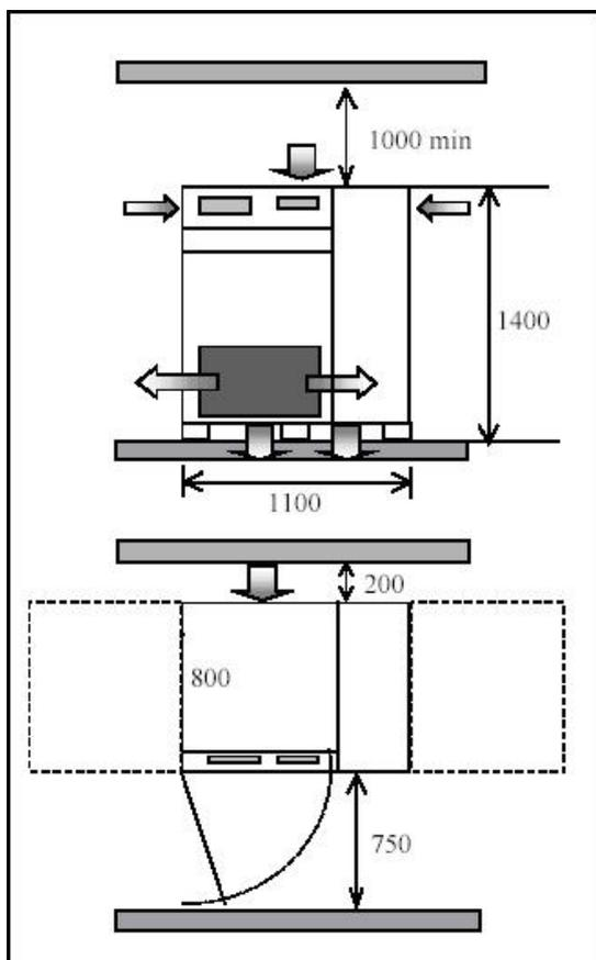
Между ИБП и стеной необходим зазор 200 мм для забора охлаждающего воздуха.
