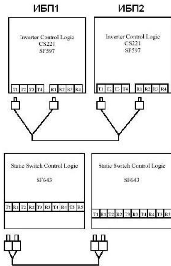
**Рисунок 13: ОПТИКОВОЛОКОННЫЕ СОЕДИНЕНИЯ – ПАРАЛЛЕЛЬНАЯ РАБОТА ТРЕХ ИБП.**
