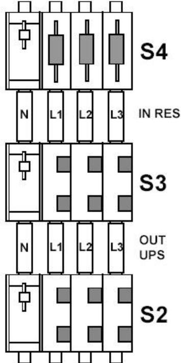
**ПОДКЛЮЧЕНИЯ РАЗЪЕДИНИТЕЛЕЙ В СИЛОВОМ ОТСЕКЕ**
