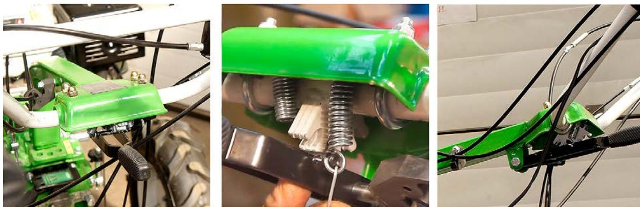
4. Закрепите ручку регулировки положения руля по центру перекладины рулевой колонки. Нажимая на данную ручку можно изменить положение поворота руля относительно оси крепления руля.
