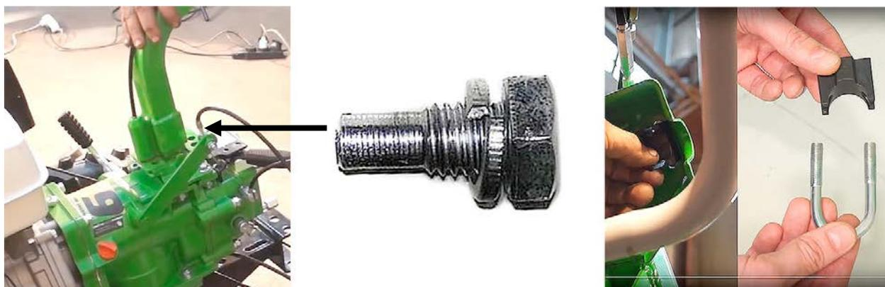
Снимите прижимное устройство и установите ручку-руль мотоблока. Закрепите ручку-руль на рулевую колонку с помощью скоб и пластиковых вкладышей, затяните снаружи концевые (колпачковые) гайки, подложив шайбы.
