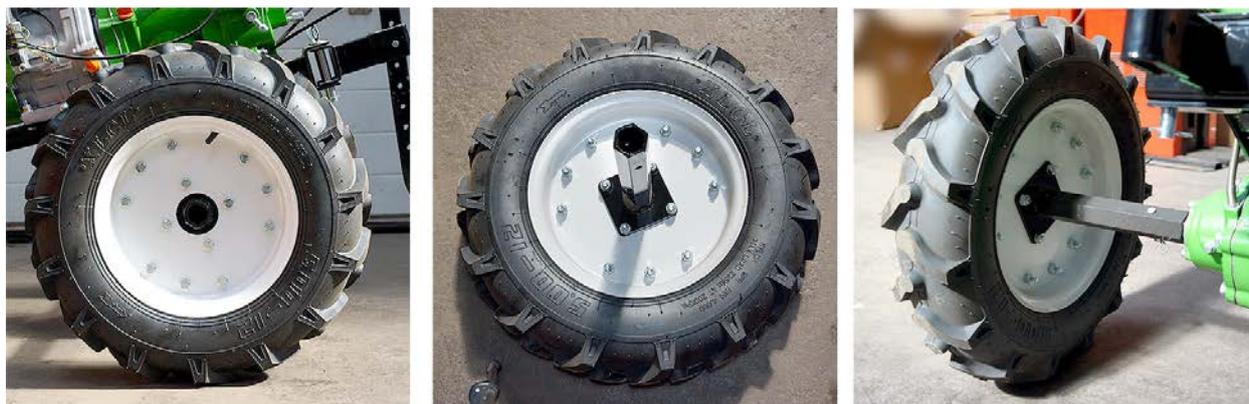
2. Поставьте мотоблок на колеса: наденьте колеса с осями на валы, выходящие из редуктора, и зафиксируйте шплинтами.
