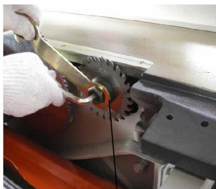
Установка полотна подрезной пилы
