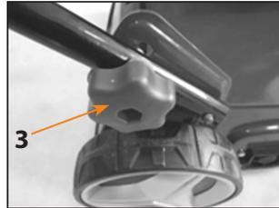
3. Соедините верхнюю часть рукоятки с нижней с помощью таких же болтов, шайб и барашков.
