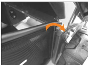
3. Установка рукоятки стартера. Медленно вытяните ручку стартера и закрепите на специальной кронштейне на рукоятке.
