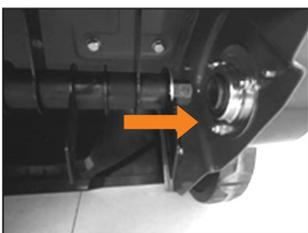
3. Закрепите вал 2 шурупами с помощью ключа.
