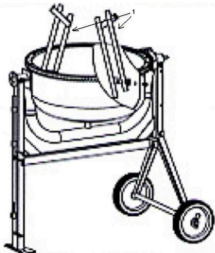
Вставьте болты M8 x 20 с внешней стороны нижнего барабана, затем установите на болты кожаные шайбы. После этого установите смешивающие ножи (1), вставив плоскую шайбу и стопорную шайбу, зажмите гайкой.
