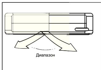
Тщательно отрегулируйте направление потока воздуха, иначе вы можете чувствовать дискомфорт или создать в помещении неравномерную температуру воздуха.
