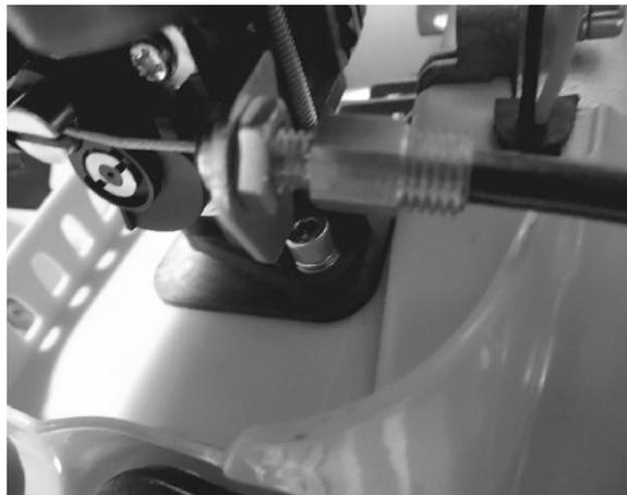
Соедините тросик привода дросселя с рычагом дроссельной заслонки
