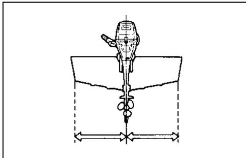
После установки мотора убедитесь, что при повороте или откидывании он не задевает какие либо части лодки.
