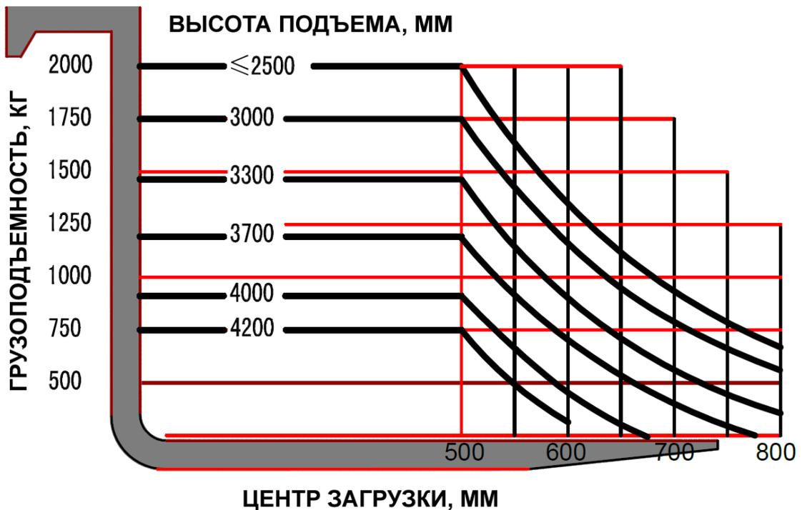
При загрузке руководствуйтесь графиком кривой нагрузки на этикетке. Грузоподъемность ричтрака зависит от высоты подъема и положения центра тяжести груза. Не допускайте перегруза.
