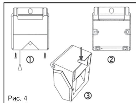
2. Прodelайте для винтов отверстия в стене; для точного выполнения отверстий используйте корпус.
