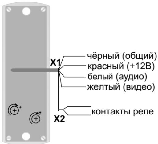
**X1:** для подключения панели к 4-х проводному видеодомофону;
